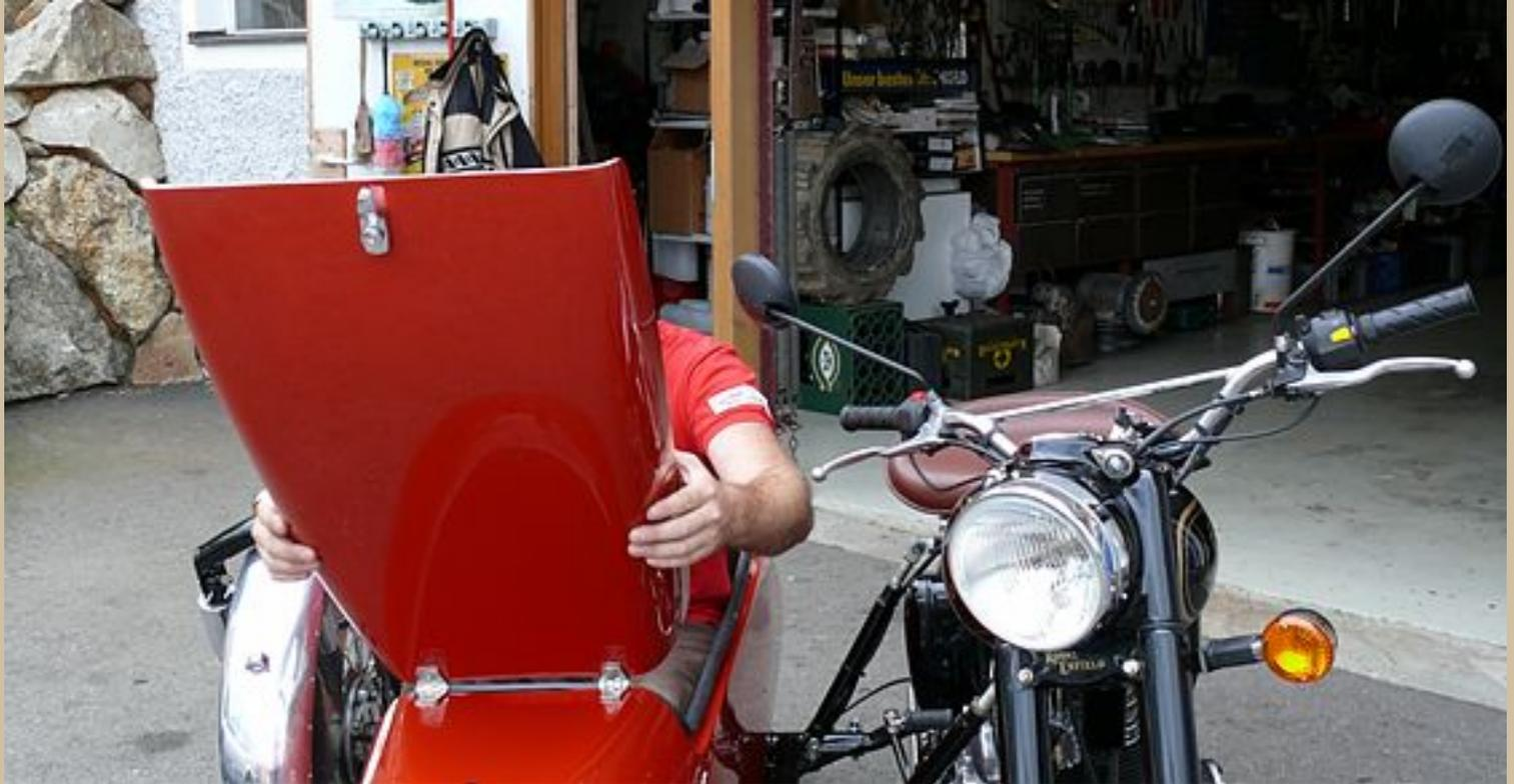
Die Frontklappe kann demontiert werden. Mit Sitz und Frontscheibe kann das Boot schnell für Passagierbetrieb hergerichtet werden.
