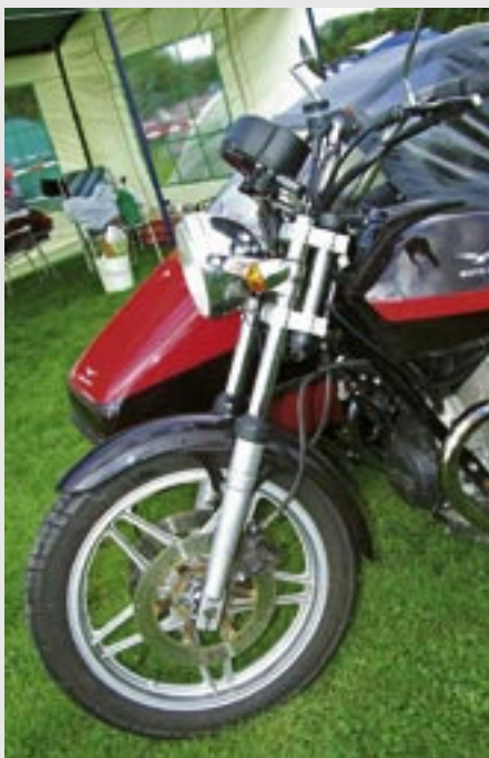
350 Euro kostet die Nachlaufverkürzung der Firma Heigl. Sie ist für fast alle Motorräder mit stabilen Gabelbrücken lieferbar. Nachteil: Je nach Motorrad muss der Kabelstrang verlängert werden, der zum Lampentopf führt.
