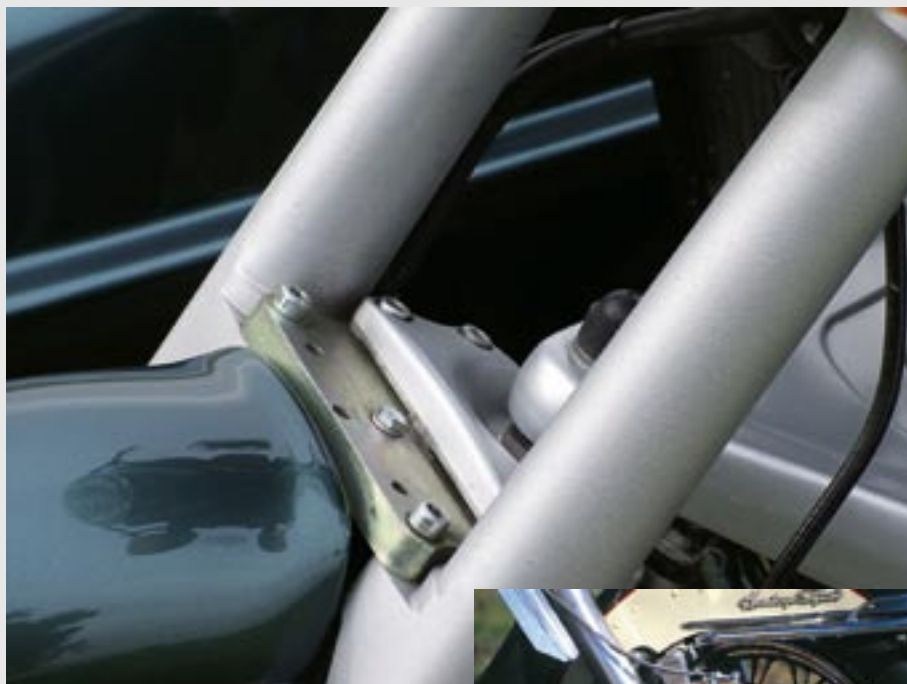
80 Euro kostet die Stahlplatte bei Tripteq-Händlern zur Verkürzung des Nachlaufs bei BMW-Viertel-Boxer-Motorrädern.
