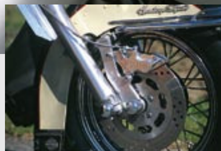
Klassische Nachlaufverkürzung der Firma Pfeiffer in Kamen-Heeren. Formteile werden mit der Achsaufnahme der Telegabel verschraubt und die Achse dadurch weiter nach vorn gesetzt. Nachteil: Kotflügel und Bremszangenhalter müssen geändert werden.
